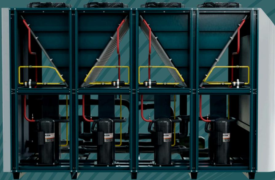
Este sistema de refrigeración emplea ventilación forzada para optimizar el intercambio de calor entre los condensadores (radiadores) y los ventiladores. El radiador, confeccionado en aluminio microcanal, se encarga de condensar el gas refrigerante, proporcionando una elevada eficiencia térmica. Para enfriar el agua, el sistema dispone de un intercambiador de calor de placas soldadas, lo que asegura la máxima eficiencia en la transferencia de calor.
