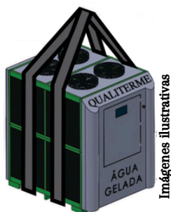
MANERA CORRECTA Montaje del equipo con torno.
